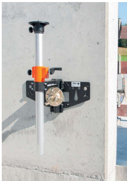
Bevestiging met ankerstaaf aan een muur
