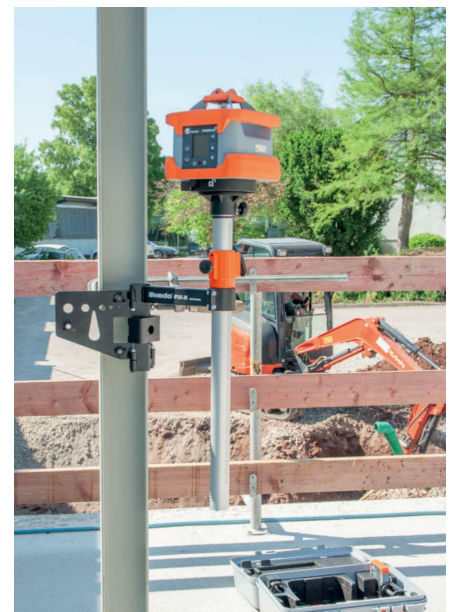
Bevestiging met schroefklem aan stalen ligger
